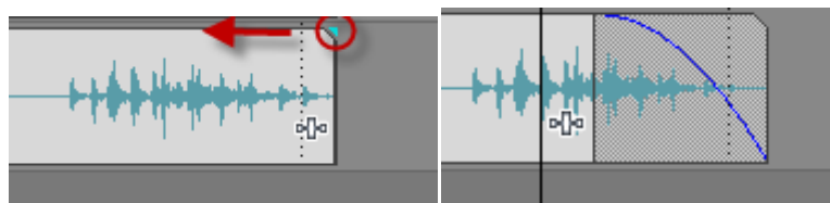
Εικόνα 12 Fade Out σε ένα ηχητικό μέρος. Είναι εμφανές ότι η ένταση στην κυματομορφή μειώνεται ομαλά μέχρι να μηδενιστεί στο τέλος.
